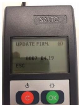
→ Das Firmware-Update läuft automatisch durch, gibt eine akustische Rückmeldung und zeigt den Fortschritt in Form eines Balkens an.
