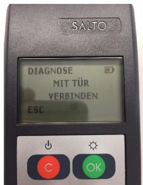
→PPD Gerät auf dem Beschlag/Zylinder halten (Funksymbol auf Funksymbol)
