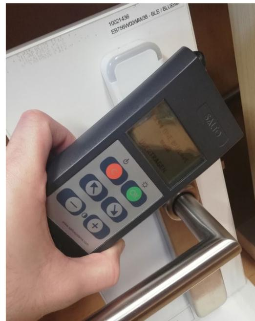
Sobald am PPD die Meldung „Übertragen“ angezeigt wird, ist die Aktualisierung der Türe fertiggestellt. **Nach der Türaktualisierung müssen die Daten wieder zurück in die Software geladen werden. Hierzu einfach das PPD wieder am PC via USB anschließen und in der SALTO Software unter System auf PPD klicken.**
