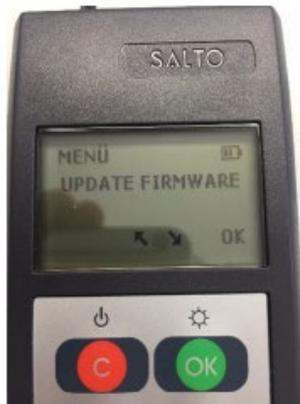
→PPD Gerät auf Beschlag/Zylinder halten (Funksymbol auf Funksymbol) oder mit Kabel verbinden
