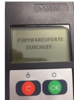
Nach Abschluss aller Updates sollte das PPD erneut mit dem Rechner verbunden werden. Nach Start von System/PPD in der Software werden alle Änderungen an die SPACE-Software zurück übertragen, damit auch dort die aktuellen Stände zur Verfügung stehen.
