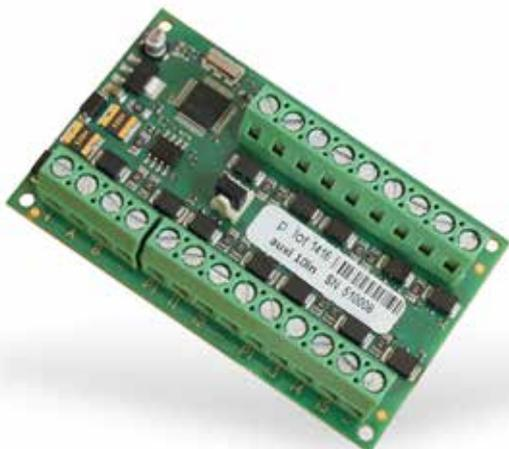
**auxi 10in** ist eine Erweiterungsplatine für die Hinzufügung von Eingängen zu den Steuerzentralen **lares** und den Kommunikatoren der Serie **gemino**.
