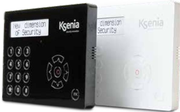
Obwohl der gleiche „form-factor“ wie bei ergo S beibehalten wird erfüllt sie im Gegensatz zu letzterer die Anforderungen an eine mechanische Tastatur (mit Laser geschnittene Tasten), wobei allerdings auf die Funktionen akustische Raumüberwachung, RFID und Temperatursensor verzichtet wurde.
