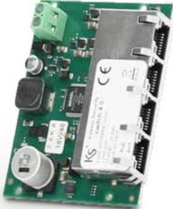
switch 4.0 ist ein Netzwerk-Switch 10/100 Mbit, der für die Verbindung der Steuerzentralen lares 4.0 mit den Touchscreen-Tastaturen ergo-T und ergo-T plus bestimmt ist. Er verfügt über 4 Netzanschlüsse, davon einen PoE (Power over Ethernet), der auch zum direkten Anschluss an eine ergo-T- oder ergo-T-plus-Tastatur verwendet werden kann. Das Gerät wird direkt über die Stromversorgung der Steuerzentrale gespeist und garantiert daher ein PoE-Backup für die Stromversorgung der Tastatur.
