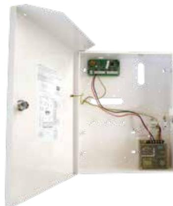
Detailansicht der Anschlussstation opis samt Schalt­netzteil, PCBA und 2A Sicherung
